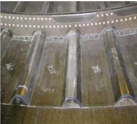
Fusoliera realizzata in Fibra di Carbonio con rinforzi in Titanio
