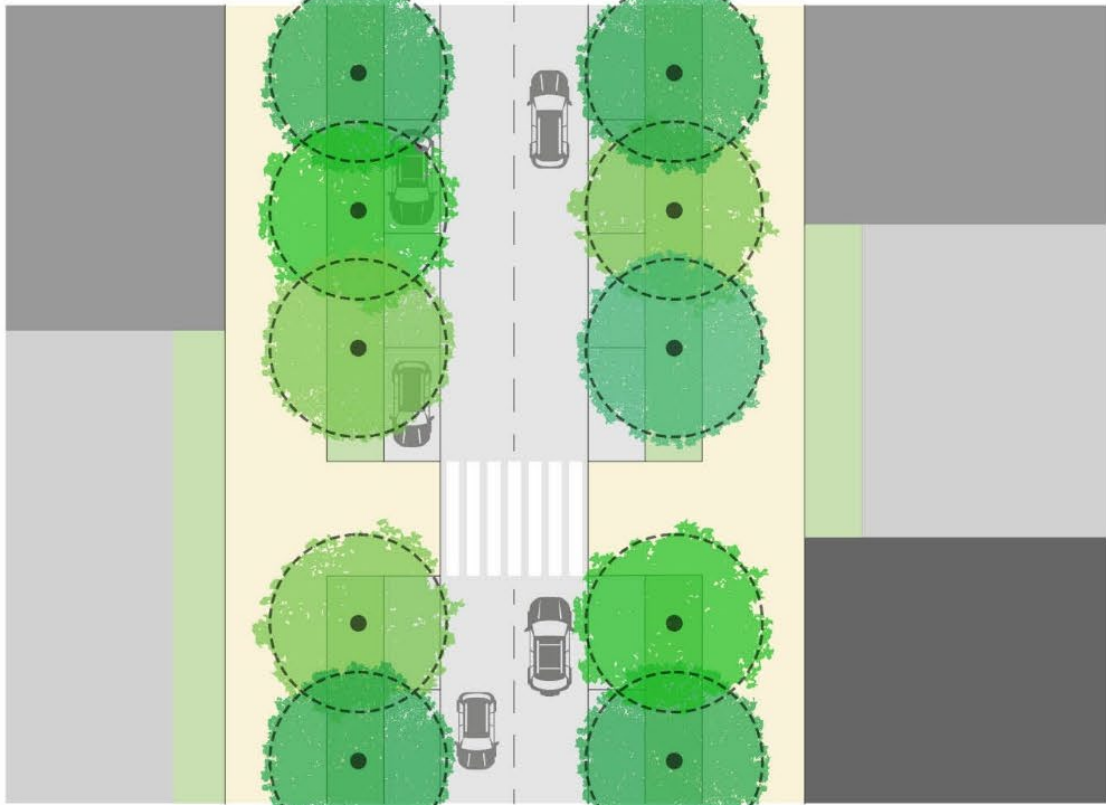
STRADA A DOPPIO SENSO DI MARCIA CON CORSIA SINGOLA E PARCHEGGI IN LINEA Una porzione di marciapiede viene desigillato per fare posto a giardini della pioggia lineari paralleli alla carreggiata. Strada e percorsi pedonali sono complanari per agevolare il deflusso delle acque piovane. I giardini della pioggia sono interrrotti in corrispondenza degli attraversamenti pedonali.
