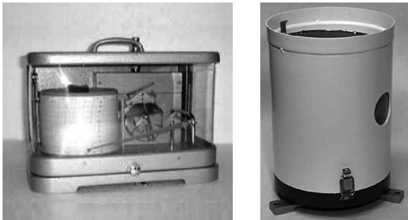
**Figura 5.7 – Pluviometro/Pluviografo.** Il sensore pluviometrico misura la precipitazione raccolta da una bocca tarata di  $1000 \text{ cm}^2$ , di forma circolare (ad imbuto) e fornisce un segnale per ogni quinto di millimetro di acqua caduta (20g). L'elemento sensibile è costituito da una coppia di vaschette basculanti.
