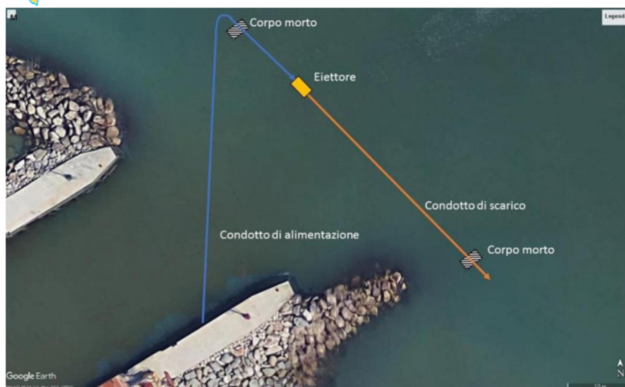
Figura 11.4.1.4 - Modalità di installazione a mare delle tubazioni.
