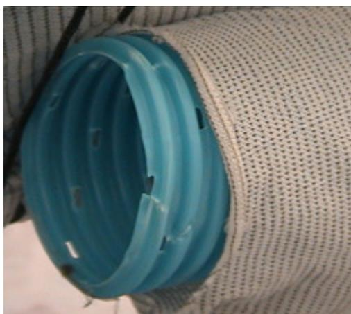
*Fig. 3.2.4.5c - Particolare del dreno e della calza in geo-tessile.*
